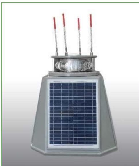
A lanterna MCL 400 é uma baliza LED autônoma de médio alcance, com potência solar incorporada, caracterizada pela sua elevada eficiência luminosa e baixo consumo, constituída por diodos LED de alta intensidade, proporcionando uma faixa luminosa de até 23 milhas náuticas.
